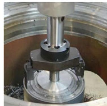
Все буровые коронки оснащены сменными режущими пластинками из высокопроизводительной режущей стали или твёрдого металла. Глубина прореза составляет 30 мм.
