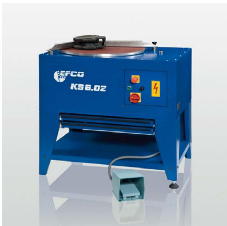
Шлифовальный стол KS предназначен для плоско-параллельного шлифования клиньев задвижек, золотников вентиляей и различных других деталей.
